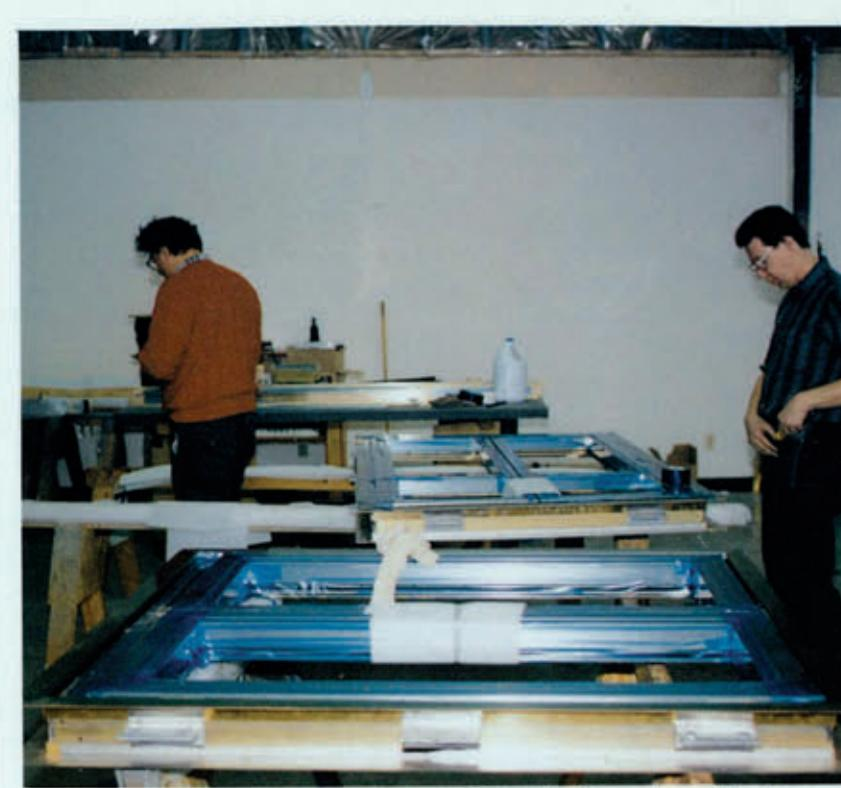
Completed window units are plastic-wrapped to protect the metal surfaces and crated for shipment. Après l'assemblage final, les cadrages sont recouverts d'un plastique destiné à protéger les surfaces métalliques, puis emballés en vue de l'expédition.
