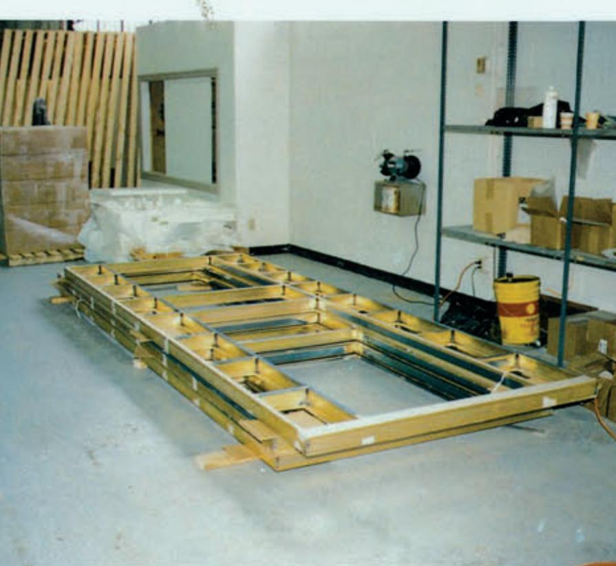
The corners are mitred, and the window frame is TIG welded using a matching filler metal. The sash components are then bolted or welded to the frame. Les coins sont assemblés et le cadrage des fenêtres est soudé par procédé TIG, en utilisant un métal d'apport qui s'harmonise bien avec les métaux. Les composants des fenêtres sont vissés ou soudés aux cadrages.
